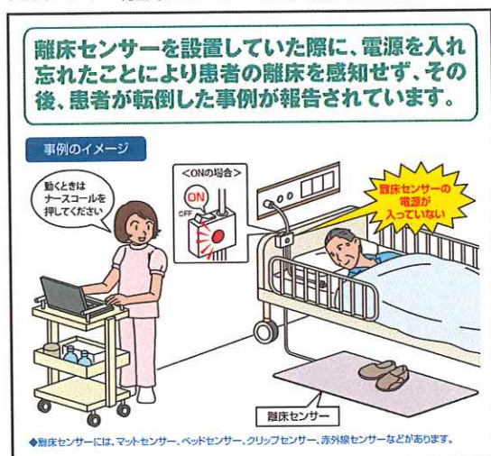
No.197 離床センサーの電源入れ忘れ
