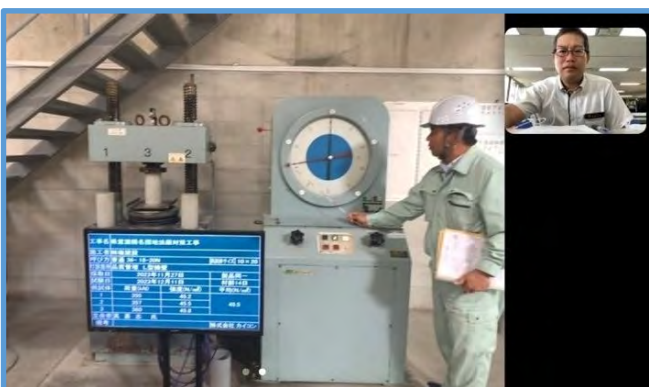
【圧縮強度試験 立会状況（工場側）】
