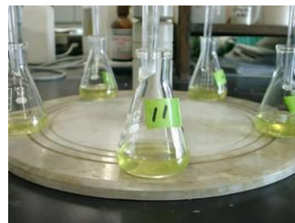
④ ろ過して抽出 (ろ過が困難な場合は上澄み液)
