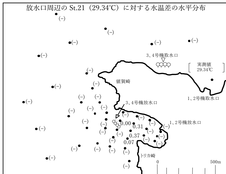
図 2-2 夏季調査の上げ潮時における水深 1m 層の水温分布(上段)および放水口周辺の水温差分布(下段)
