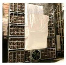
大型鉄製コンテナ乾燥システム
