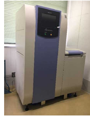
液体シンチレーションカウンタ （β線） トリチウムの測定に使用
