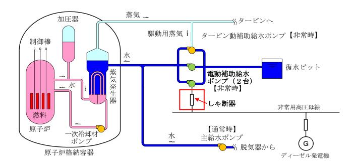
【玄海原子力発電所 概略系統図 (非常用電源の機能検査時)】
