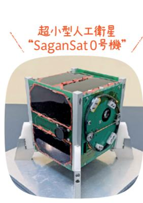
県とJAXA（宇宙航空研究開発機構）との連携プロジェクト「JAXAGA」の一環で、県内の高校生が開発した超小型人工衛星「SaganSat 0号機」を開発。SaganSat 0号機には、「赤外線を使った地球気候の調査」など、高校生が発案した3つのミッション（機能）を搭載。8月5日に米国から国際宇宙ステーションへ向け打ち上げられ、8月29日に宇宙空間へ放出されました。今後は、佐賀県立宇宙科学館に設置された地上基地局で、高校生たちが運用・分析を目指します。遠い宇宙からどんな画像やデータが届けられるのか楽しみですね！
