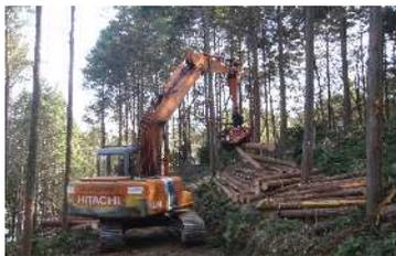
プロセッサによる造材作業（神崎市）
