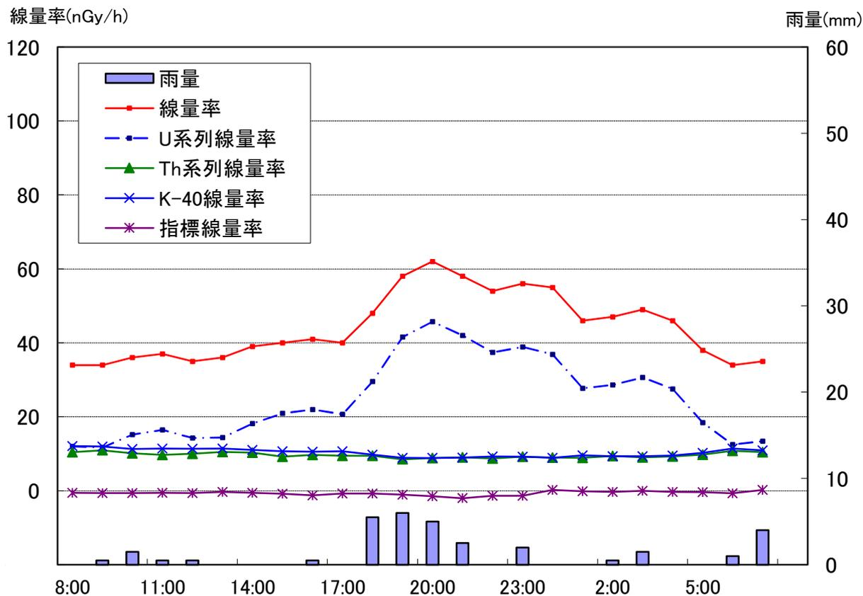
県モニタリングポストの代表局として京泊先局を選定し、NaI(Tl)シンチレーション式検出器付属の多重波高分析器で得られたデータを用いてスペクトル分析を行った。
