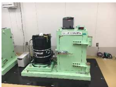
ゲルマニウム半導体検出器（ \gamma 線） ガンマ線の測定全般に使用
