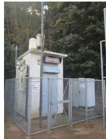
モニタリングポスト【石室局：唐津市】 空間線量率、気象データを測定
