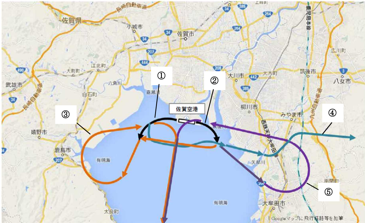
図4 計器飛行の場合の離陸経路イメージ
