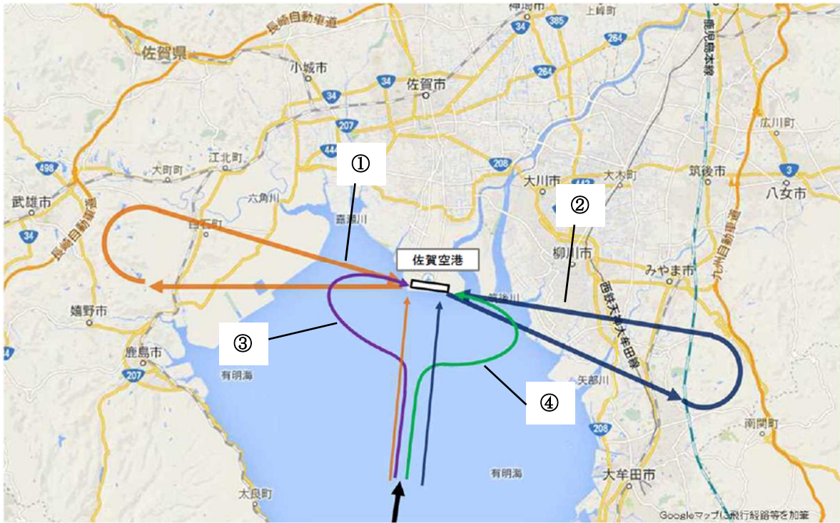
図5 計器飛行の場合の着陸経路イメージ
