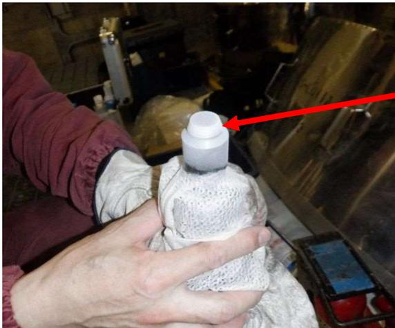
浸透探傷検査 (弁体)
