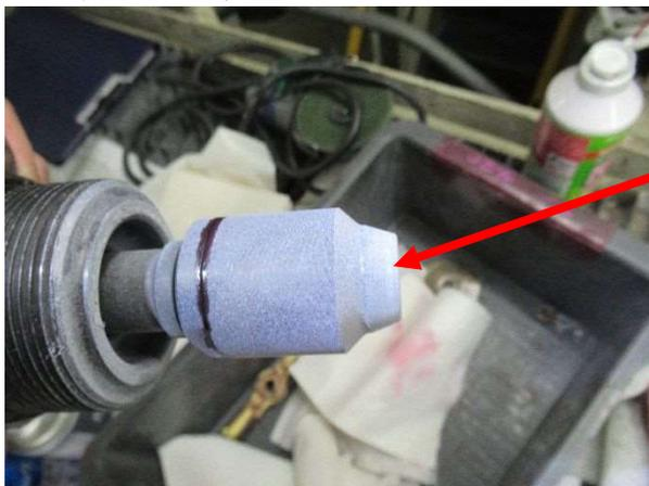
浸透探傷検査 (弁体)
