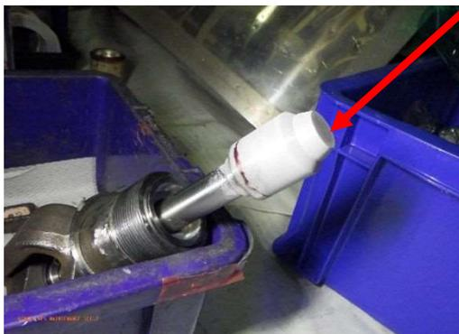
浸透探傷検査（弁座・弁体）
