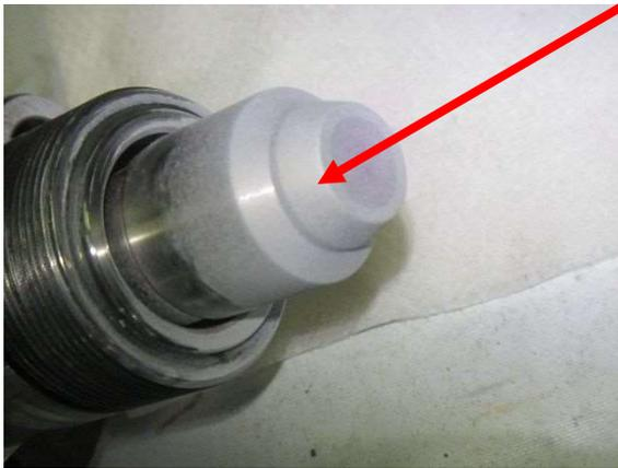
浸透探傷検査 (弁座・弁体)
