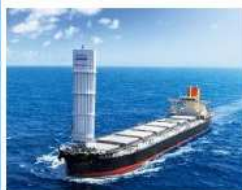
風力補助推進船 出典：大島造船所
