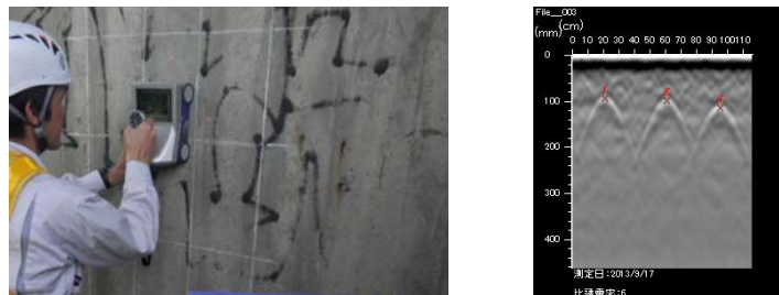
写真 3-1-13 電磁波レーダー法
