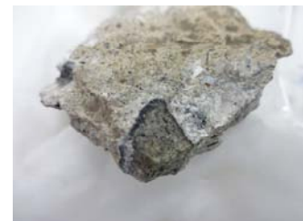
写真 3-1-21 PC 橋の ASR 事例
