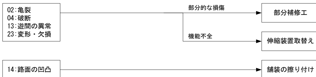
図 4-2-16 伸縮装置の補修工法選定フロー
