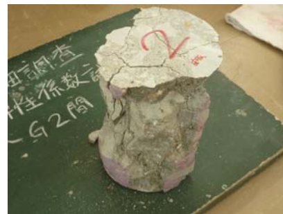
写真 3-1-12 静弾性係数試験実施後状況
