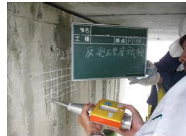
写真 3-1-10 反発硬度試験例
