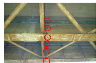
写真 3-1-4 ひずみゲージ貼付例
