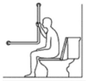
逆L字の手すりで立ち上がろうとすると懸垂で上体を引き上げるになってしまう
