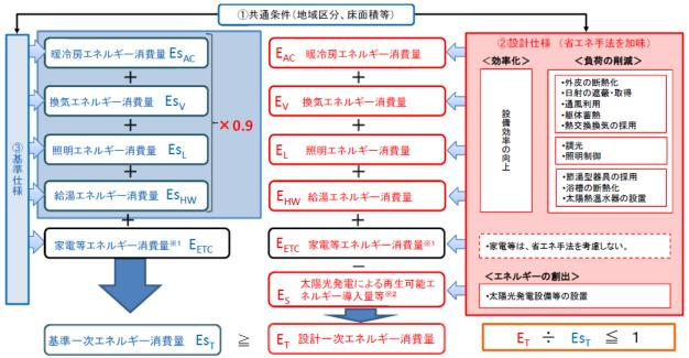
※1 家電及び御理のエネルギー消費量。建築設備に含まれないことから、省エネルギー手法は考慮せず、床面積に応じた同一の標準値を設計一次エネルギー消費量及び基準一次エネルギー消費量の両方に使用する。 3
