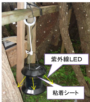
LED捕虫器は(株)みのる産業のLEDキャッチャーを使用した ◎捕虫器は地面から高さ20cm~50cm程度の位置で設置する
