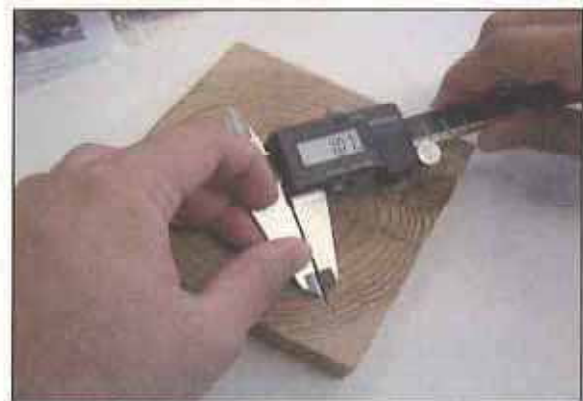
内部割れ測定状況
