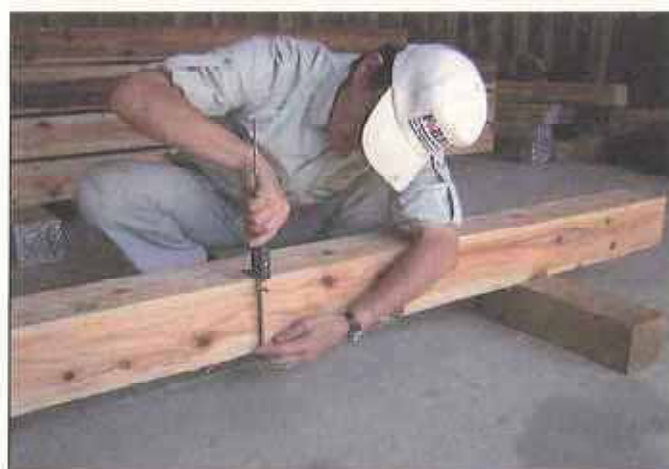
材せい測定状況
