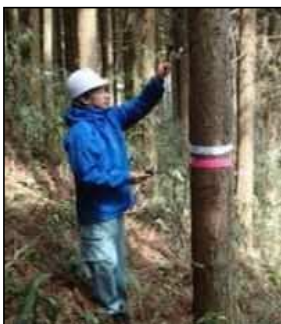
非破壊強度試験状況
