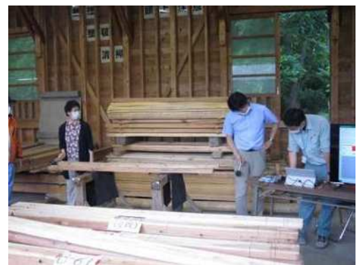
サガンスギの強度測定の実演
