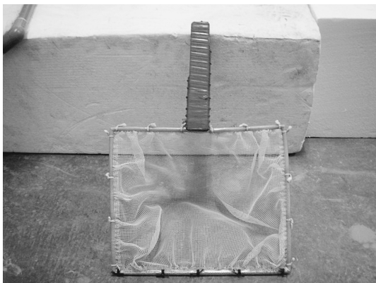
写真4 2 mm 稚貝回収用 セラミックを篩いやすい形状 のたも網。目合いは1 mm。
