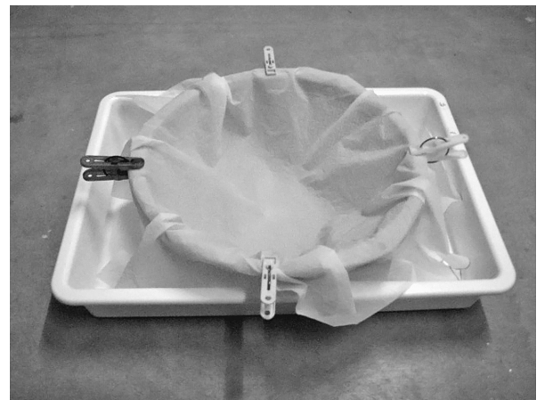
写真1 D型幼生および200 \mu m幼生回収用ナイロンネット 調理用ざるにネットを洗濯ばさみで固定。 ネット目合い：D型幼生用：30 \mu m ；200 \mu m幼生用：80 \mu m
