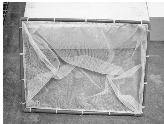
写真5 7~10 mm 稚貝回収用 大量のセラミックと稚貝を篩い易い形状。 目合い：3 mm
