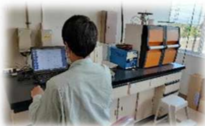
写真1 土壌分析 (CNコーダーによる炭素、窒素の測定)
