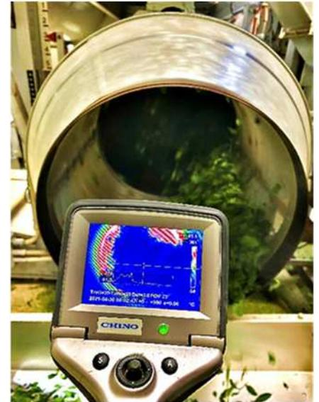
炒葉機の釜底温度測定の様子
