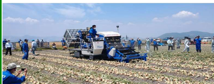
大型コンテナを使用したピッカーの性能調査
