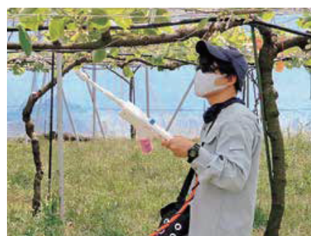
図7 静電風圧式受粉機（試作機）の作業状況 上：ナシ、ノズル先端カバー付き仕様 下：キウイフルーツ、短ノズル使用
