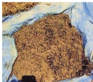
△ 腐食した疎水材（もみがら）
