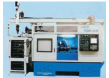
歯車研削盤FGS-21N ※CNC:コンピュータ数値制御 Computer Numerical Controlの略
