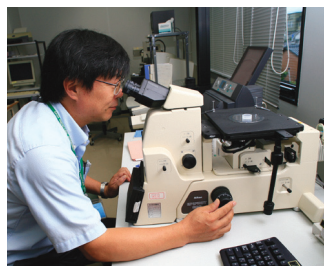
光学顕微鏡をのぞきながら、接合部分の組織構造を調べる玉井氏
