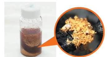
吸着剤が金を吸着して沈殿
