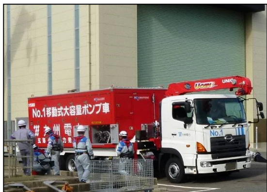
◇移動式大容量ポンプ車の設置
