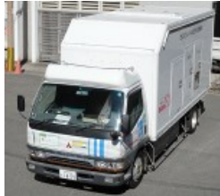
高圧発電機車
