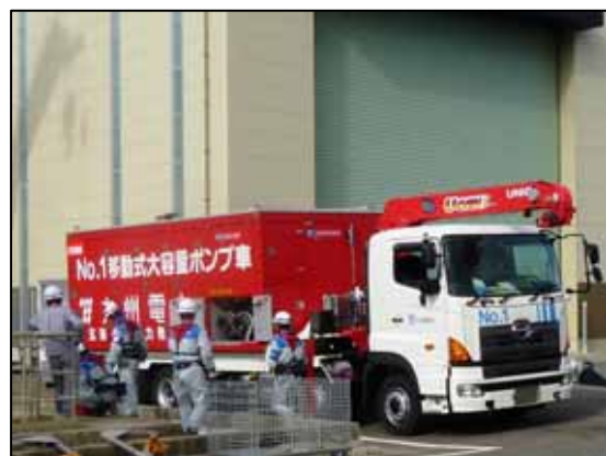
移動式大容量ポンプ車の設置
