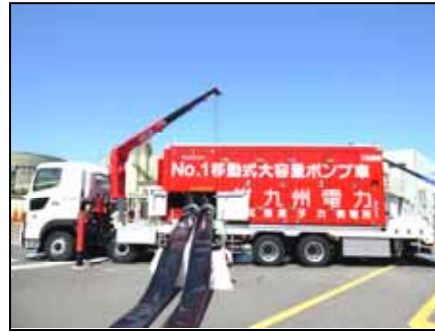
移動式大容量ポンプ車
