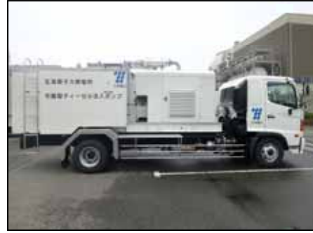
可搬型ディーゼル注入ポンプ
