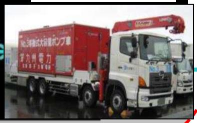
移動式大容量ポンプ車
