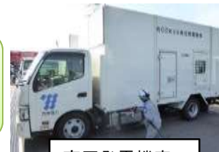
高圧発電機車
