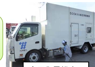
高圧発電機車
