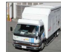
高圧発電機車
