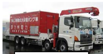
移動式大容量ポンプ車
