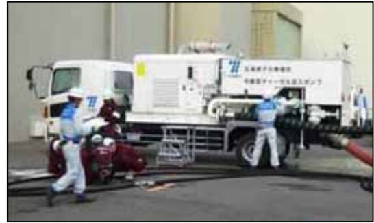
可搬型ディーゼル注入ポンプによって冷却水を供給する訓練
