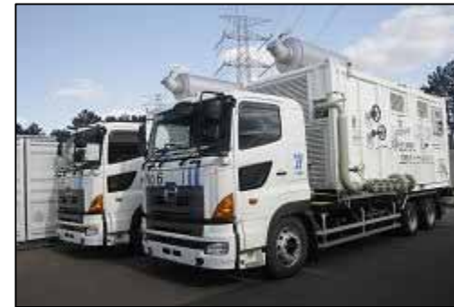
可搬型ディーゼル注入ポンプ
