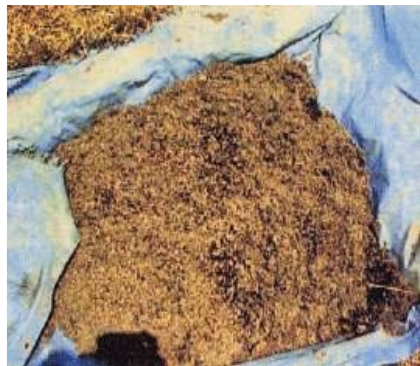
△ 腐食した疎水材（もみがら）
