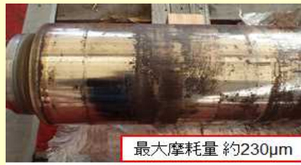
最大摩耗量 約230 \mu m 参考: H26耐久走行試験時の車軸 (標準軌走行距離: 約2.5万キロ)
