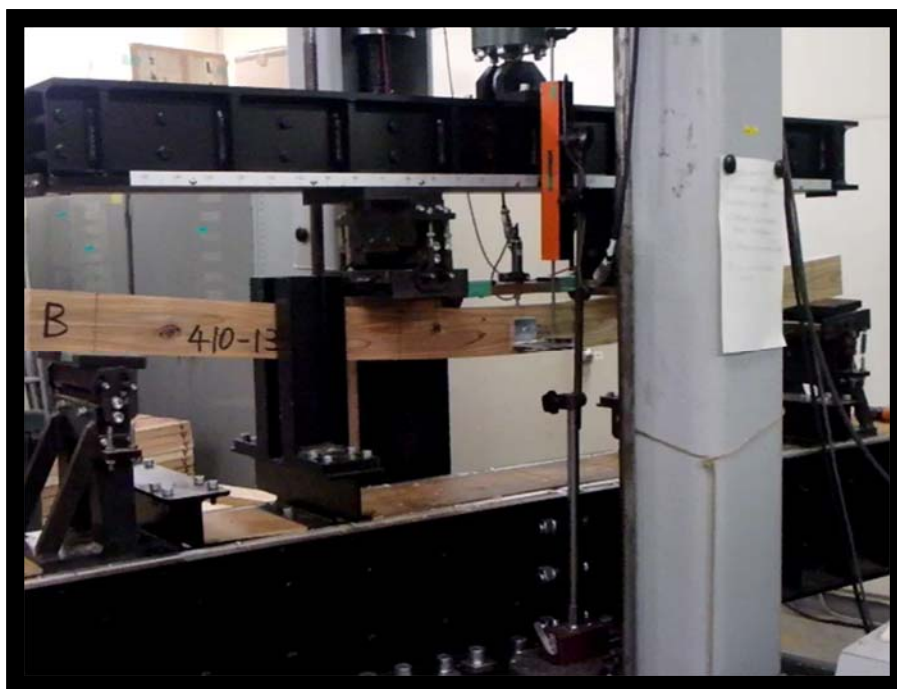
実大強度試験の状況
