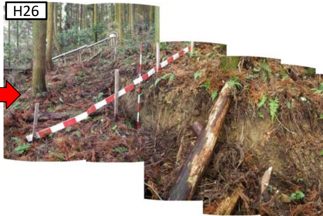
森林内の亀裂・段差の拡大及び亀裂の一体化を確認
