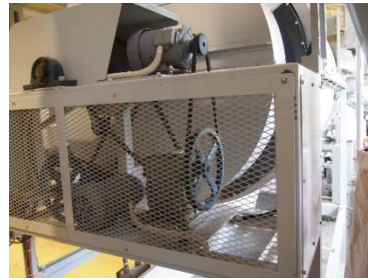
写真2 改造した駆動部
