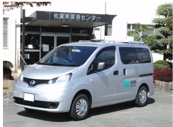
モニタリングカー及びサーベイカー ➤ 空気中の放射線などを移動しながら測定できる環境放射線測定車
