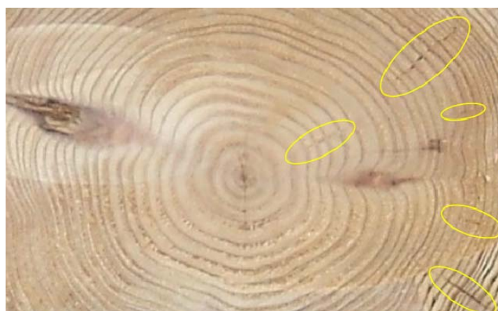
図-2 NO.33 の内部割れ状況
