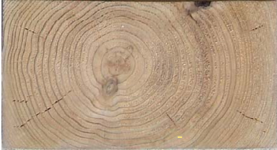
図-2 NO.42の内部割れ状況
