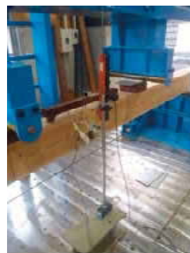
写真-2 変位計の設置
