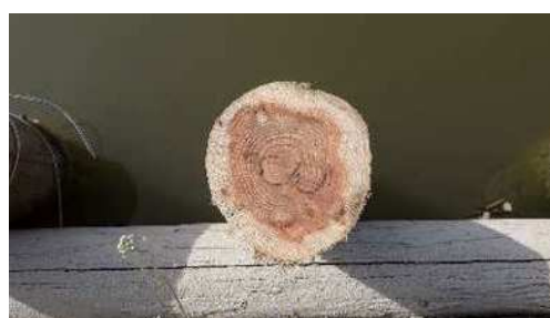
写真-3 水性キシラモン3W塗布杭
