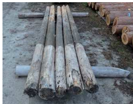
写真-4 調査地④の引抜杭
