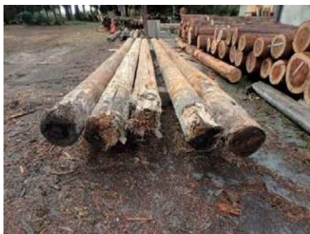
写真-3 調査地③の引抜杭
