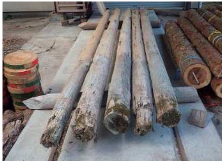
写真-1 調査地①の引抜杭
