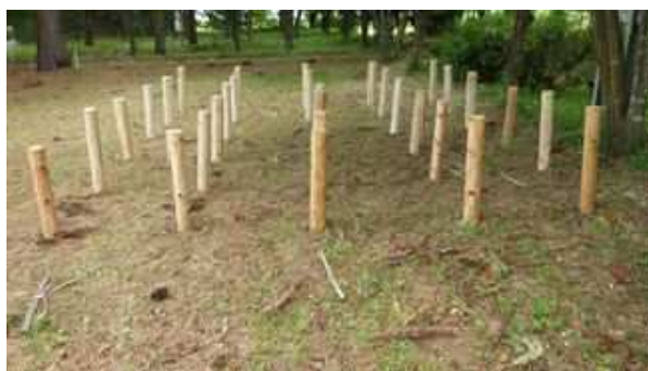
写真－4 野外暴露試験杭の設置状況
