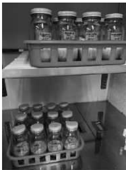
写真-6 恒温恒湿室での腐朽操作
