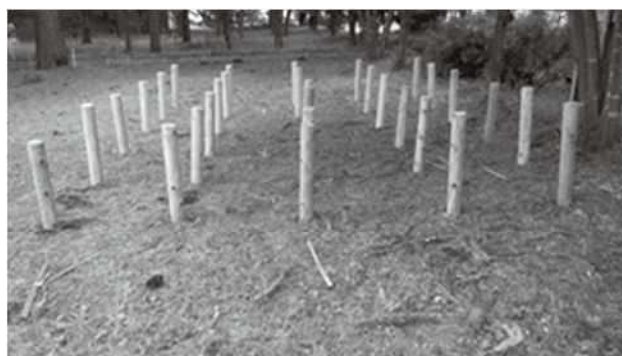
写真－4 野外暴露試験杭の設置状況
