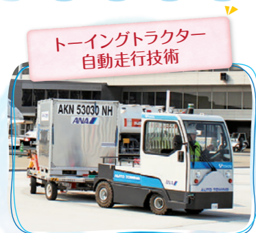
荷物を運ぶコンテナけん引車両が自動で走ります。
