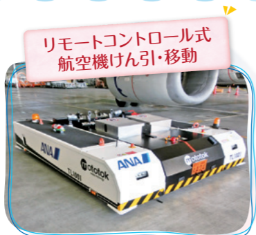
航空機のけん引や移動をリモコン操作で安全かつ簡単に行えます。
