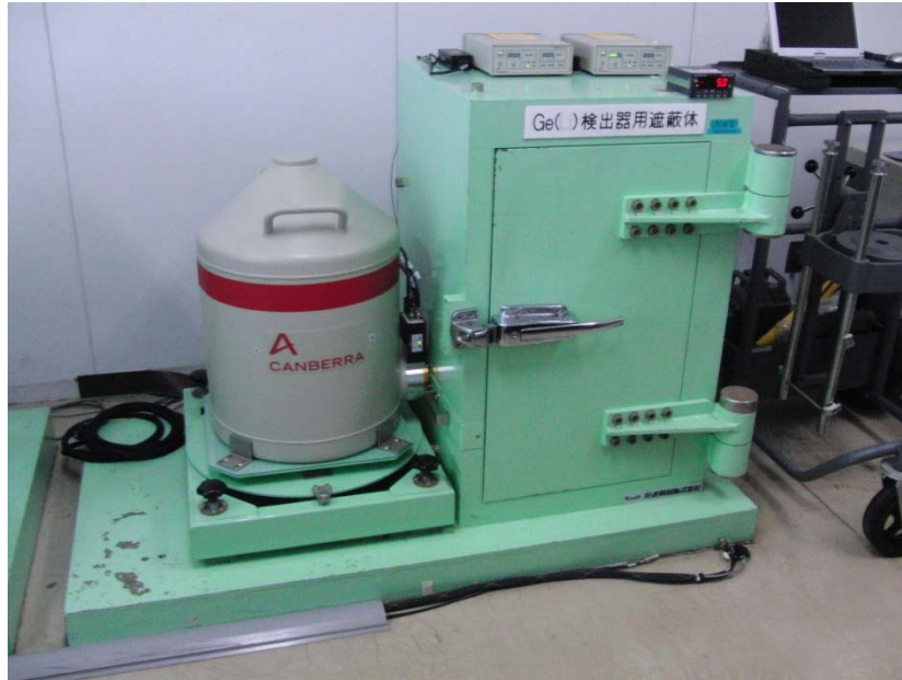
ゲルマニウム半導体検出器【環境センター】 ➤ 環境試料中に含まれる放射性物質の量を測定
