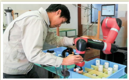
AIとロボットを組み合わせた検査工程の自動化
